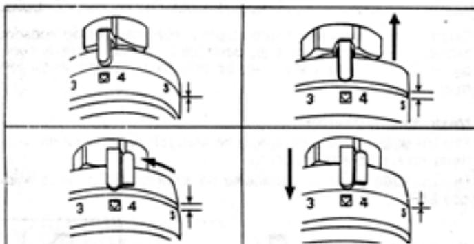
Toto nastavenie komfortu sa dá kedykoľvek zmeniť, alebo vrátiť do pôvodného stavu. Umiestnenie kolíčka z výroby je označené na hlavici bodkou a zodpovedá plnému rozsahu otočenia.
