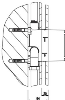
Acordați o atenție specială marcajelor de maxim și de minim de pe eticheta manșonului. La montaj trebuie să aveți în vedere grosimea stratului ceramic superior (fainata și adezivul) care trebuie să se încadreze în intervalul de toleranță de pe etichetă. Intervalul de toleranță este de 20 mm.
