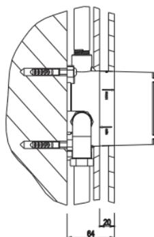
Pri montáži keramického obkladu treba dbať na to, aby štítky z puzdra ležali v tolerancii 20 mm.
