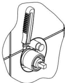
Pred zaključno montažo najprej očistimo lepilo oz. malto s tulca in pokrova, da ne bi prišlo do poškodb kromanih površin. V naslednjem koraku ob keramiki z nožem odrežemo odvečni del tulca, pri tem pa pazimo, da z nožem ne poškodujemo kromanih delov.
