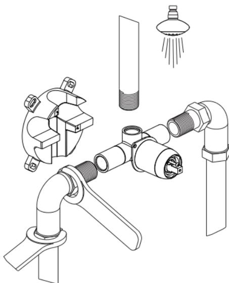
Vyberieme podmietskú batériu z krytu, odstránime ochranné puzdrá a batériu priložíme na predpripravené vývody vody. Pred montážou na rozvody vyznačíme pre plastový box na stenu upevňovacie otvory (F8) a vyvrtáme ich. Batéria by nemala byť uchytená až do konečnej hĺbky vrtu v stene. Po pripojení mosadzného telesa batérie na vývody vody zaskrutkujeme tromi samoreznými skrutkami 16 plastový box o stenu.
