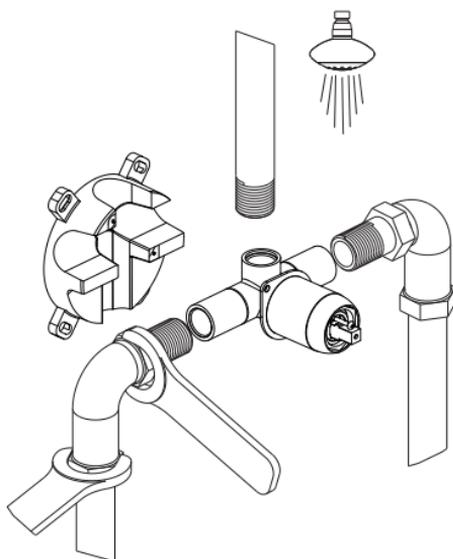
Scoateți bateria din carcasa izolatoare îngropată, și adaptați bateria în instalația pregătită. Înainte de montajul în instalație, este necesar să marcați și să executați găurile (DN 8) pentru fixarea Plastobox pe perete. Pentru reglarea adâncimii finale, carcasa nu ar trebui fixată prea rigid. După montajul în instalație, prindeți bateria pe postamentul din plastic cu șuruburi autofiletante 3 x 16.
