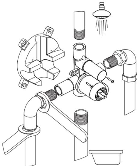
A falba süllyesztett szerelvény alapegysége két részegységből áll:
