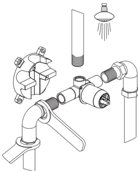
Podometno ohišje vzamemo iz embalaže, odstranimo zaščitni tulec, ter prilagodimo ohišje na v naprej pripravljeno vodovodno napeljavo. Pred montažo na napeljavo, je potrebno označiti in izvrtati luknje (F 8), za pritrditev Plastobox-a na steno. Ohišje zaradi končne nastavitve globine ne sme biti preveč togo vpeto. Po končani inštalaciji na napeljavo, pritrdimo kovinsko ohišje na plastični podstavek s samoreznimi vijaki 3 x 16.
