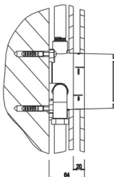
Ypatingą dėmesį atkreipkite į žymas "Max" ir "Min" kevalo etiketėje. Klajuodami sienos plyteles atkreipkite dėmesį į leistinas ribas, kurios yra 20 mm.
