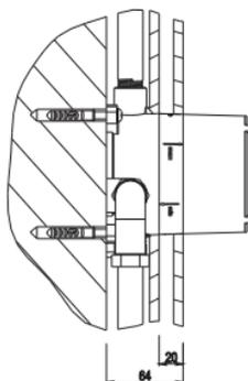
Podczas montażu należy zwrócić szczególną uwagę na oznaczenia max i min na tulei plastikowej. Koniecznie należy przewidzieć górną warstwę okładziny ceramicznej, która powinna mieścić się w pokazanym zakresie tolerancji. Zakres tolerancji wynosi 20 mm.
