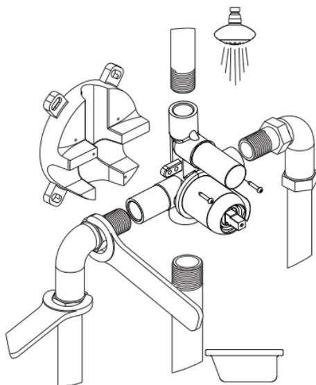
Batéria pre podmietskú montáž sa skladá z dvoch montážnych modulov:
