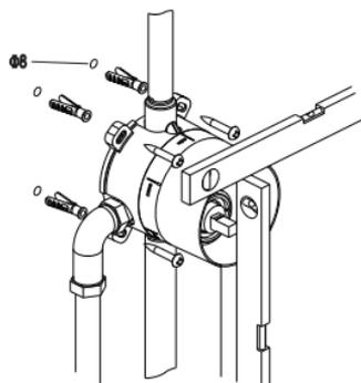
Vložte přiložené plastové hmoždinky 8 x 40 do vyvrtaných děr a dále nasadte vrchní pouzdro Plastoboxu. Vyrovnajte podomítkové tělo vertikálně a horizontálně, jako pomoc můžete použít hrany pouzdra. Finálně pevně přitáhněte šrouby 5 x 40 a nasadte kryt k ochraně modulu před poškozením.
