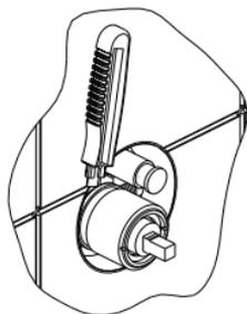
Înainte de asamblarea finală, curățați adezivul sau mortarul de pe manșon, respectiv de pe capac, pentru a evita deteriorarea suprafețelor cromate. În următoarea etapă, tăiați de-a lungul plăcilor ceramice partea în exces din manșonul de plastic folosind un cuțit. Aveți grijă să nu deteriorați părțile cromate cu lama.
