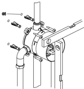
Introduceți diblurile din plastic 8 x 40 în orificii și fixați manșonul Plastobox. Așezați la nivel carcasa îngropată pe orizontală și pe verticală, pentru ajutor folosiți marginile manșonului. La final, strângeți ferm cu șuruburi de 5 x 40 și așezați capacul pentru a proteja armătura împotriva deteriorării.
