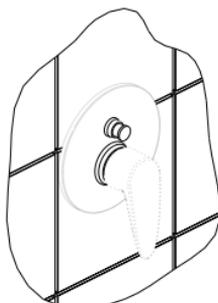
Nakonec nainstalujte vrchní díl podomítkové baterie (rosetu) a vhodný ovládací prvek příslušný pro tento díl (páku).
