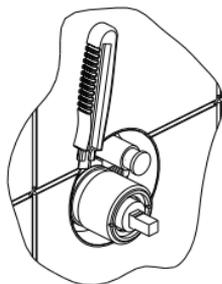
Vor der Endmontage zunächst den Klebstoff bzw. den Mörtel von Hülse und Deckel reinigen, um die Beschädigungen der verchromten Oberflächen zu vermeiden. Im nächsten Schritt die Keramik entlang den überschüssigen Hülserteil mit einem Messer wegschneiden, dabei darauf achten, keine verchromten Teile mit der Klinge zu beschädigen.
