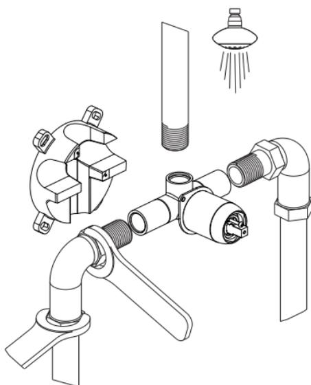
Uzidno kućište izvadimo iz pakovanja, odstranimo zaštitni osigurac, te montiramo na unapred napravljenu vodovodnu instalaciju. Pre montaže, potrebno je izbušiti rupe (svrdlo  $\varnothing 8$ ) za pričvršćenje Plastobox-a na zid. Kućište zbog podešavanja konačne dubine montaže, ne bi trebalo biti previše čvrsto stegnuto. Nakon montaže na instalaciju, pričvrstimo mesingano kućište na Plastobox za samonareznim vijcima.
