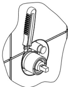
Prije konačne montaže završne ploče, najprije očistimo ljepilo odnosno žbuku sa tuljca i pokrova, da ne bi došlo do oštećenja kromiranih površina armature. U sljedećem koraku, uz keramiku nožem odrežemo višak tuljca, vodeći računa da nož ne oštećuje kromirane dijelove armature.
