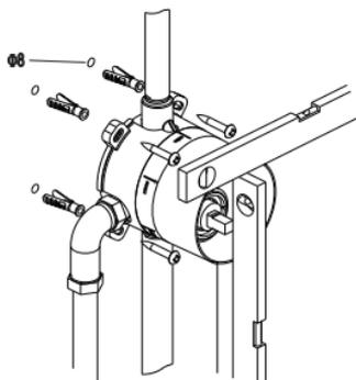
Następnie należy przymocować do ściany puszkę plastikową na kołkach montażowych 8 x 40. Zestaw należy wypoziomować (do poziomowania użyć krawędzi uchwyty głowy wewnątrz tulei). Na końcu mocno dokręcić całość za pomocą śrub 5 x 40 i nałożyć plastikową tuleję chroniącą armaturę przed uszkodzeniami.
