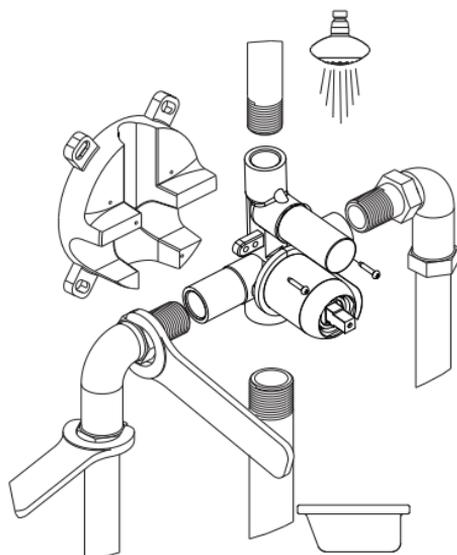
Zestaw do montażu baterii podtynkowych:
