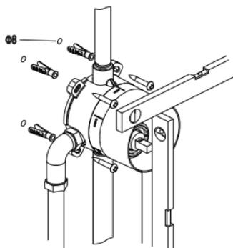
Vložíme priložené plastové nástavce 8 x 40 do otvorov a nasadíme plastový box. Teleso podomietkovej batérie zarovnáme v horizontálnom a vertikálnom smere, k tomu sú nápomocné obruby puzdra. Nakoniec pevne zaskrutkujeme skrutkami 5 x 40 a osadíme kryt, aby bola batéria chránená pred poškodením.
