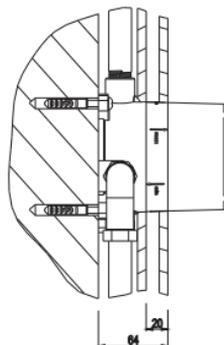
Besondere Aufmerksamkeit auf die Bezeichnungen Max und Min auf der Hülsetiketten legen. Bei der Montage die obere Keramikschicht, die im Toleranzbereich des Etiketts liegen soll, berücksichtigen. Der Toleranzbereich beträgt 20 mm.
