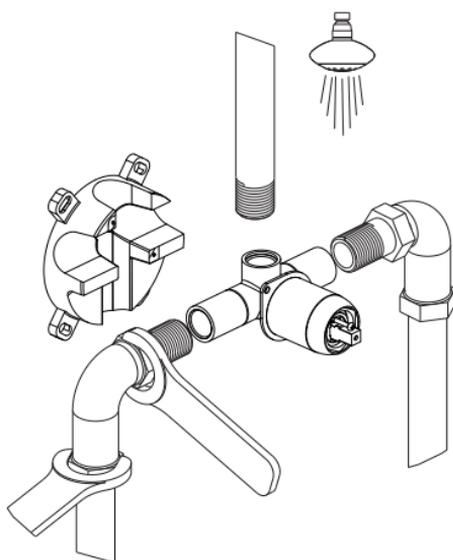
Uzidno kučiće izvadimo iz pakiranja, odstranimo zaštitni tuljaci, te montiramo na unaprijed napravljenu vodovodnu instalaciju. Prije montaže, potrebno je izbušiti rupe (svrdlo  $\varnothing 8$ ) za pričvršćenje Plastobox-a na zid. Kučiće zbog podešavanja konačne dubine montaže, ne bi trebalo biti previše čvrsto stegnuto. Nakon montaže na instalaciju, pričvrstimo mesingano kučiće na Plastobox za samonareznim vijcima.
