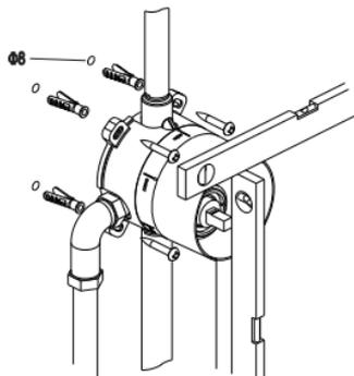
Die mitgelieferte Kunststoffeinsätze 8 x 40 in die Bohrungen einsetzen und die Plastobox Hülse aufstecken. Das Unterputzgehäuse horizontal und vertikal nivellieren, dazu sind die Hülseränder behilflich. Am Ende mit Schrauben 5 x 40 festschrauben und den Deckel aufsetzen, damit die Armatur vor Beschädigungen geschützt wird.
