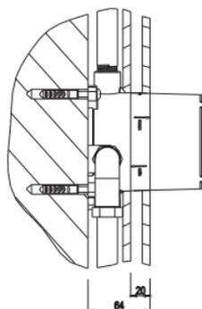
Zvláštní pozornost věnujte maximální a minimální značce na štítku pouzdra. Při montáži je nutné počítat s horní keramickou vrstvou obkladů, která musí ležet v rámci tolerančního pole štítku. Rozsah tolerance je 20 mm.
