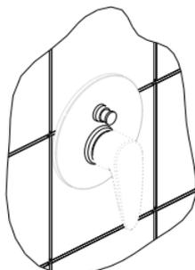
Na koniec, należy zainstalować ozdobną rozetę, zablokować ją plastikowym o-ringiem i przymocować odpowiedni uchwyt.
