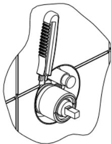
Pre konačne montaže završne ploče, najpre očistimo lepilo odnosno žbuku sa osiguraca i poklopca, da ne bi došlo do oštećenja hromiranih površina armature. U sledećem koraku, uz keramiku nožem odrežemo višak osiguraca, vodeći računa da nož ne oštećuje hromirane delove armature.
