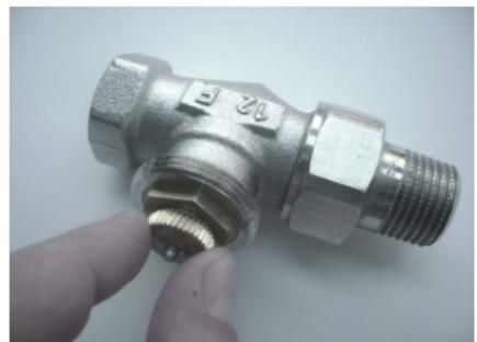
Namontujeme späť termostatickú hlavicu, ručnú hlavicu alebo ochrannú krytku z ventila.
